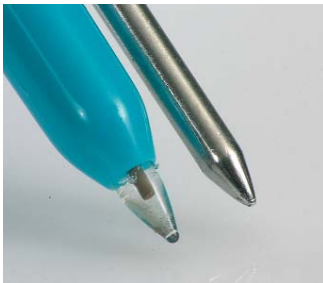
Cabeza de sonda pH2 para sustancias semisólidas
