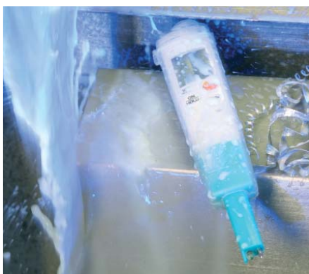
La funda "TopSafe" protege el instrumento en condiciones industriales adversas
