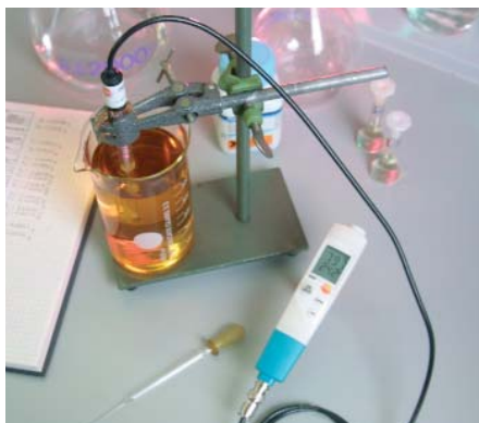
testo 206-pH3 facilita la conexión de sondas de pH externas
