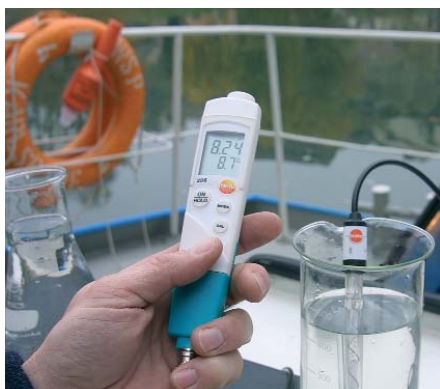
Compensación de temperatura automática en sondas externas con sensor de temperatura
