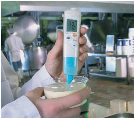
testo 206 pH2 es ideal para realizar mediciones en sustancias viscoplásticas
